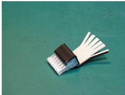
Afgeknipt en voorbereid om te “strippen”.
