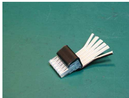
Afgeknipt en voorbereid om te “strippen”.
